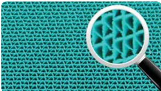
Функционирует как очиститель от запахов и газов, уничтожает бактерии. Твердый катализатор – диоксид титана, нанесенный в видеnano-размерных частиц, обладает сильнейшими окисляющими свойствами и под воздействием света 90% вредных химических соединений (формальдегид, аммиак, сероводород и др.) быстро разлагаются на безвредные составляющие.
